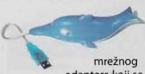
mrežnog adaptora koji se priključuje na USB, a koji ima oblik delfina. U njemu se nalazi Realtek RTL8150, kontroler za prenos signala sa USB na Fast Ethernet sa klasičnim brzinama od 10/100 Mb/s. Delfin košta desetak dolara.
