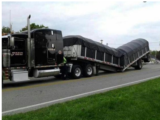
Слика 6.4: Лом прикључног воила условљен претоваром ( www.pinterest.com )
