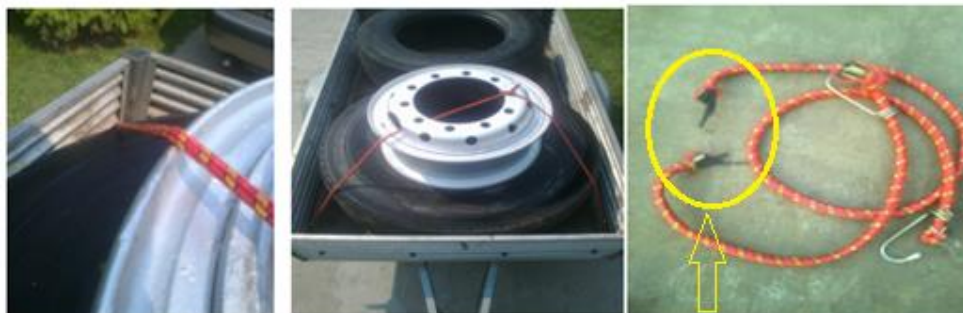
Слика 7.3: Везивање терета гуменом траком обмотаном тканином са кукицама [1]
