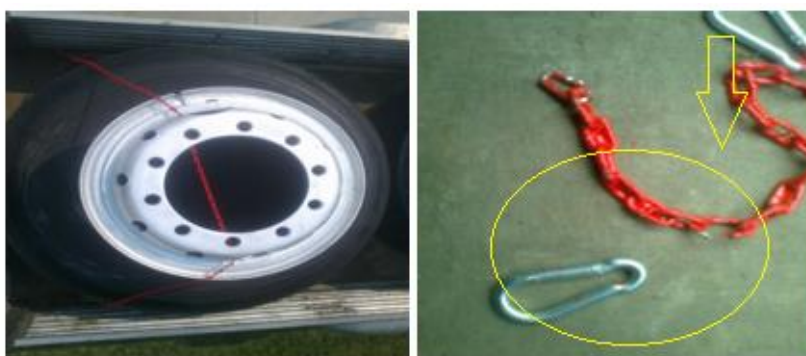
Слика 7.4: Везивање терета челичним ланцем и челичним кукама са осигурачима [1]
