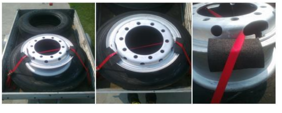
Слика 7.6: Везивање терета полиестерском траком са затезачем [1]
