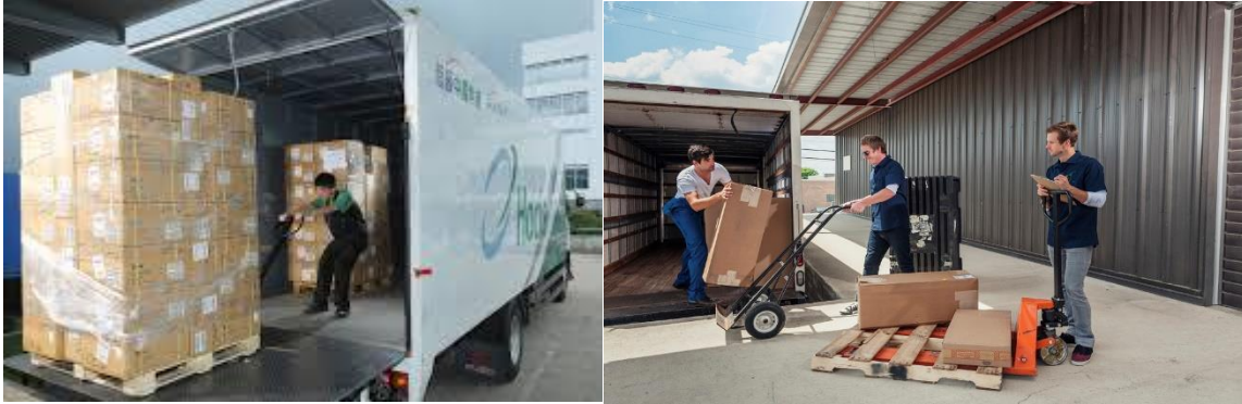
Слика 4.2: Средства за манипулацију у виду утоварних рампи и ручних палетара (извор: www.hactl.com www.excelsior.ph )
