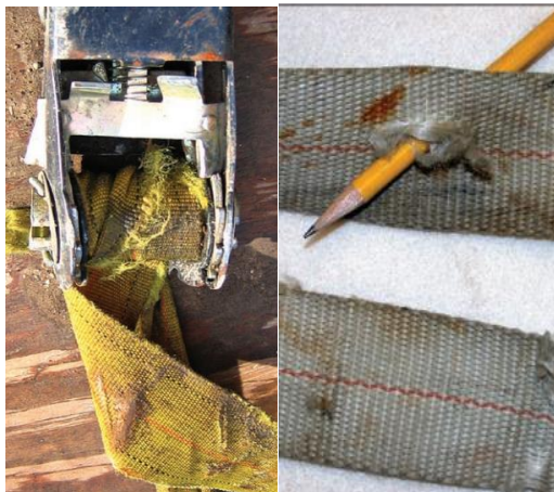
Слика 3.2.4: Оштећења и кварови полиестерских трака (извор: Securing the Load A Guide to Safe and Legal Transportation of Cargo and Equipment)
