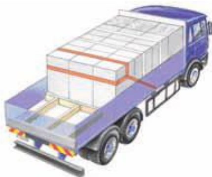
Слика 4.2.3: Везивање путем угаоних трака (Извор: П. Велибор Сигиран утовар-Безбједан превоз)
