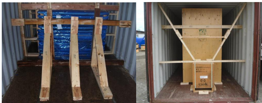
Слика 4.1.3: Блокирање путем дрвених гредица (извор: www.pack-n-rail.com , www.westerncrating.com )
