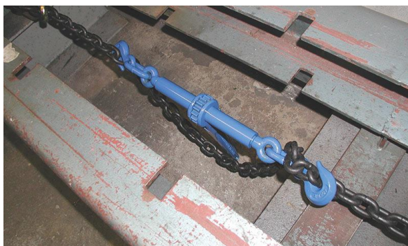
Слика 3.3.2: Елемент за притезање ланца (извор слике www.owprofessional.com )
